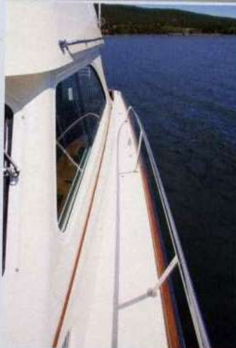
Sopra, passaggi laterali di corrette dimensioni, protetti da solide battaglie e serviti da mancorrenti fissati alla sovrastruttura portano alla zona prodiera. A destra, il fly di dimensioni contenute, con timoneria e divano a C per gli ospiti.
